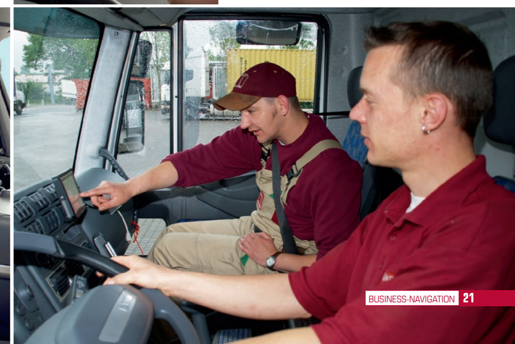
Bei der Navigation sind entweder alle Daten im Gerät gespeichert, oder die Zentrale sendet den Fahrern aktuelle Routen per Funk zu.
