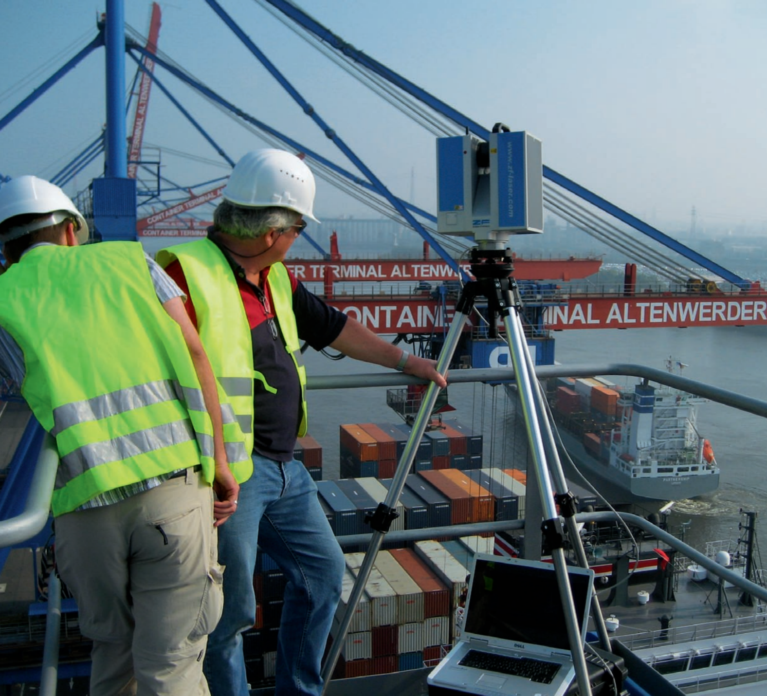
Laserscanner müssen auch im harten industriellen Einsatz gute Ergebnisse liefern, wie hier bei der Anlagendokumentation im Hamburger Hafen.
