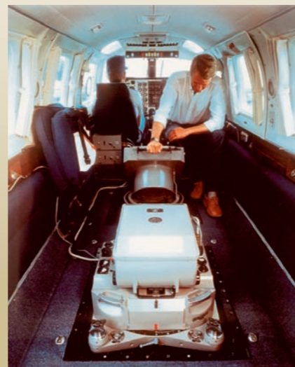
Im Flugzeugboden wurde diese Reihenkamera von Zeiss zur Aufnahme von Luftbildern eingebaut.
