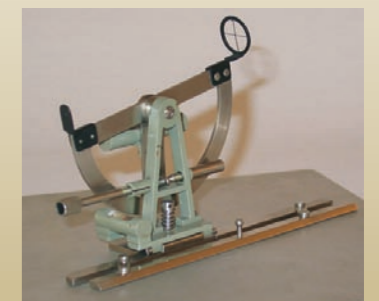
Kippregel mit Messtisch, der auf das Gewinde eines Fotostativs passt.
