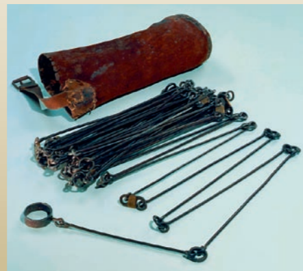
Messkette aus dem 19. Jahrhundert. Die einzelnen Kettenglieder besitzen eine identische Länge.
