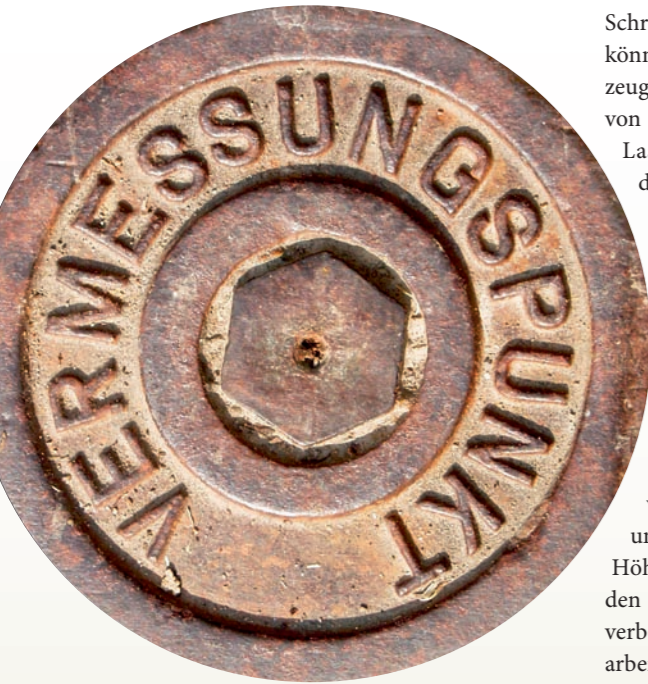
Der im Boden markierte Punkt dient dem Geodäten als Ausgangs- oder Zielpunkt seiner Vermessung.
