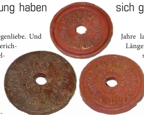
Rathmayerplatten aus Keramik sicherten unterirdisch das Dreiecksnetz.
