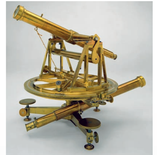
Handlich und genau: Der 1806 im Institut von Georg von Reichenbach und Joseph Liebherr gefertigte Repetitionstheodolit.
